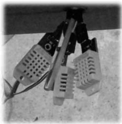
Gambar 5. Sensor suhu DHT22
