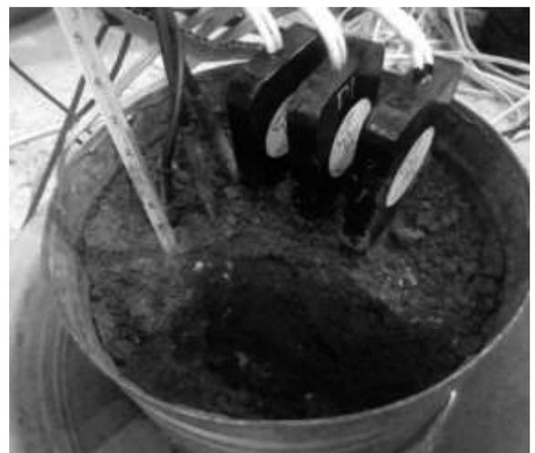
Gambar 6. Sensor kelengasan tanah
