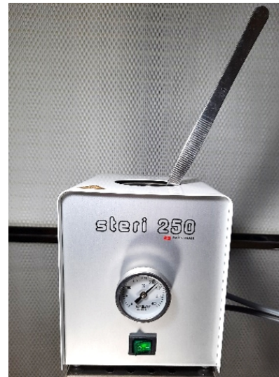
Gambar 3. Sterilisasi Peralatan Menggunakan Glass Bead Sterilizer (Dokumentasi Pribadi)
