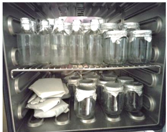
Gambar 1. Sterilisasi Peralatan Menggunakan Oven (Dokumentasi Pribadi)
